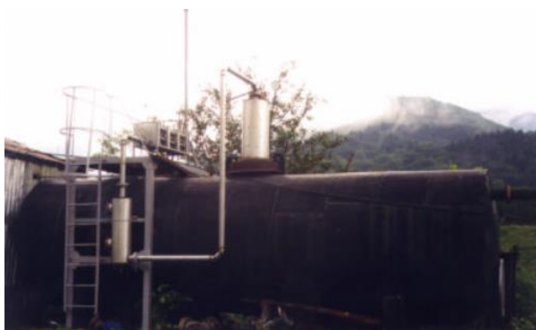
Ilustrația 30: instalație montată pe degazeificator pentru separarea metanului în Cozia (Rosca 2007)
