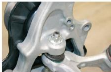
Verbaufall (exemplarisch) Leichtbaumutter Bild rechts: Produktionhalle Kaltfließpressestelle am Standort Spaichingen
