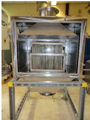
DBD Modul für ca 1000 m³/h, 1 KW im Gehäuse
